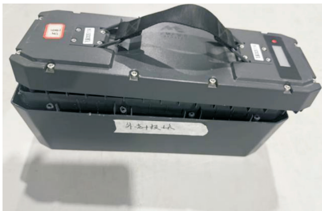
图 12-1 移动电源外观损坏
