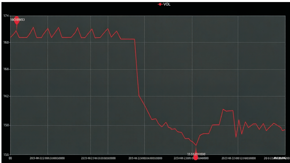
图 14-7 无人机电池的电压随飞行时间的动态变化过程
